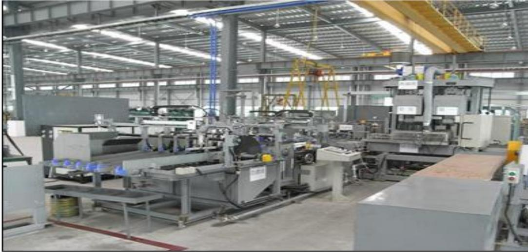
ドアガードバーの熱処理機
